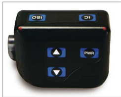
Das kompakte und sehr leichte Beltpac mit versiegelten Tasten mit Li-Ionen Akku und innen liegender Antenne.
